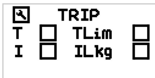
Рисунок Д.4 – Флаги защитного отключения
