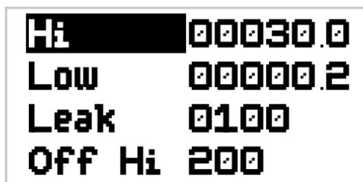
Рисунок Д.11 – Установка предельных значений по току
